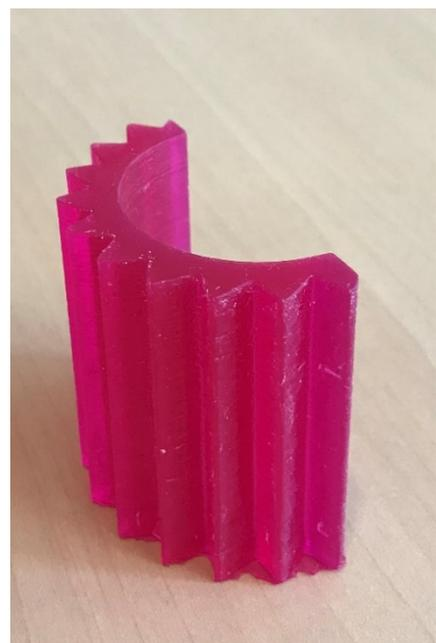
図 2 UV 樹脂製凹凸部品
