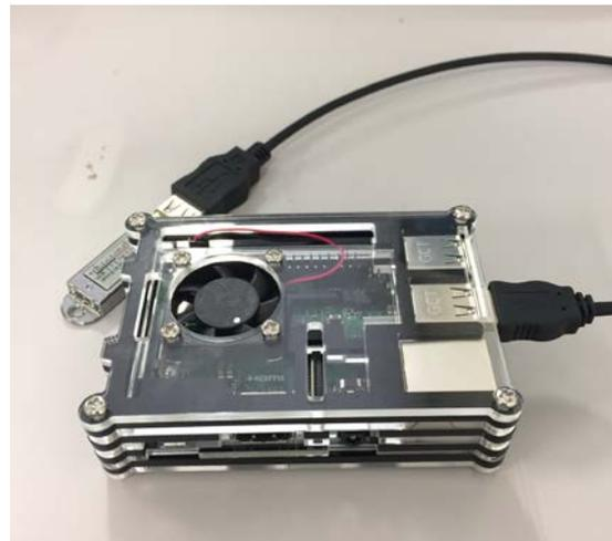
図 RaspberryPi を用いた温度測定器
