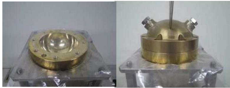
図 1 音速を測定するための球形共鳴器
