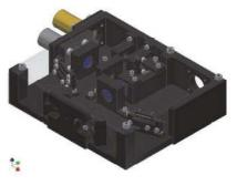
図 開発したレーザ変位計
